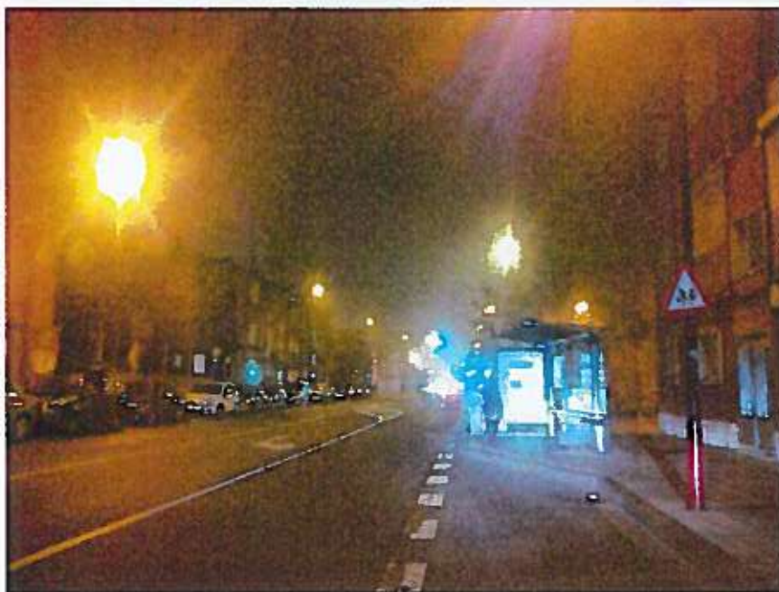
Calle Cigüña. Iluminación insuficiente y luminarias de vapor de sodio
